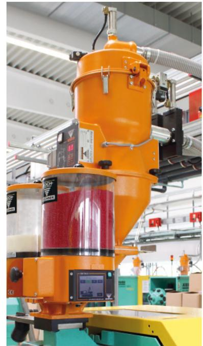
Ideal, wenn neben Masterbatch noch Antistatikum oder Flammschutzmittel beigegeben werden muss: 2 KEM-TOUCH Dosiergeräte mit Adapterflansch AZ, Materialtrichter Z5 und Förderabscheider TmA8 für zwei Materialien, wie Neuware und Mahlgut.
