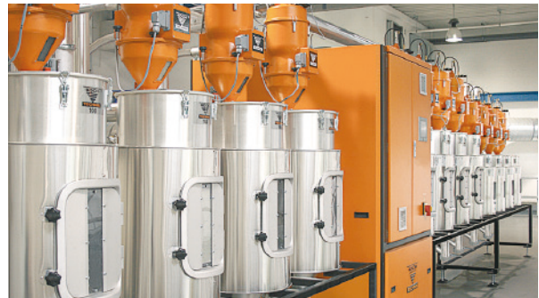
CKT 500 Granulattrockner mit 12 Trocknungsbehälter
