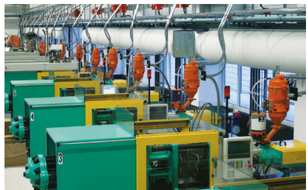
中央材料供应系统中的色母机 - 工业 4.0 灵活材料供应系统的典范
