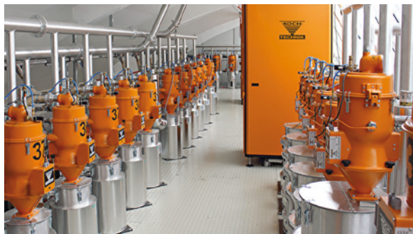
中央干燥系统共有三台 CKT 干燥空气干燥机，为宝洁制造有限公司的 38 个干燥容器提供高达 1600 m 3 /h 的干燥空气。
