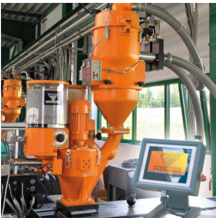
带两个 Kö 配料站和新型 SLT 和 MCT 控制单元 (带 7 " 彩色触摸显示屏) 的 G 型搅拌机
