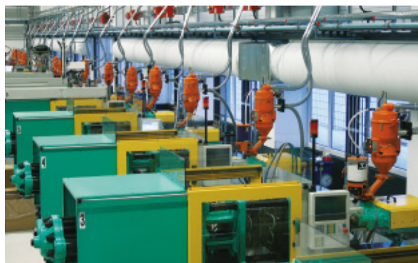
Centralny system zaopatrzenia w materiały z bezpośrednim barwieniem – Przykładowy system elastycznego zaopatrzenia w materiały z zastosowaniem przemysłu 4.0
